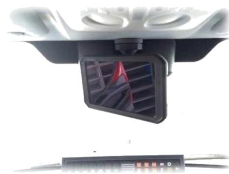
Bei Rückwärtsfahrten in der Nacht verfügt die Kamera über 4 Hochleistungs-Infrarot LEDs, die einem Ausleuchtungsbereich von 7m x 5m garantiert. Für verbesserte Sicht sorgt auch der automatische Weißabgleich, der Licht- und Sonneneinstrahlungen minimiert.
