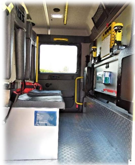
Die abwaschbaren Sitzschalen sind mit Kopfstützen und Gurtbändern in langer Ausführung ausgestattet, sodass ein anlegen der Gurte auch mit Schutzkleidung möglich ist.
