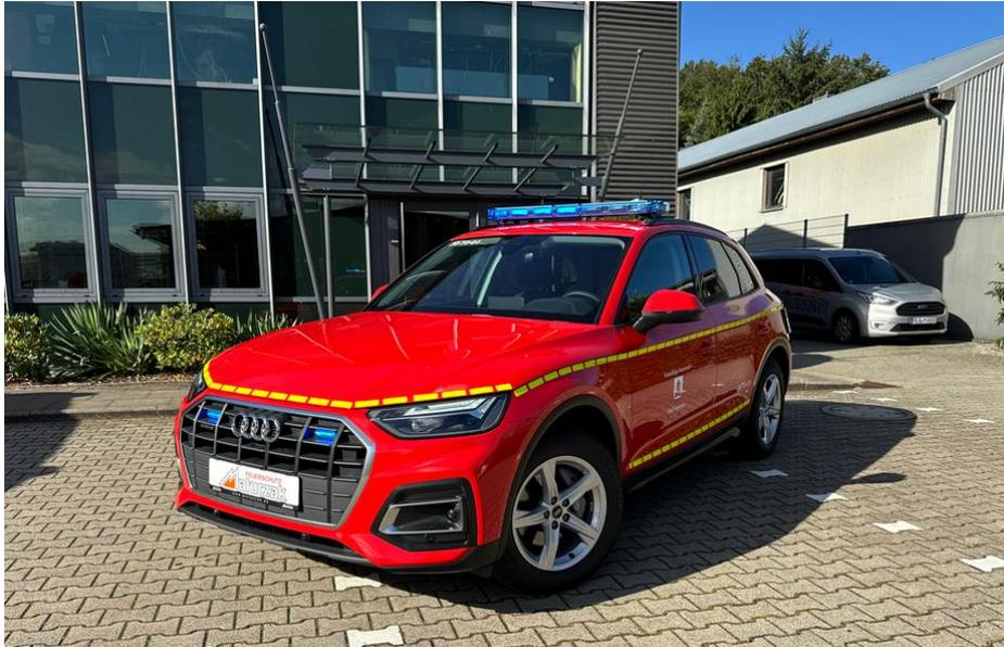
Ein **Kommandowagen** (KdoW) ist ein Feuerwehrfahrzeug, das der Leitung der Feuerwehr als Transportfahrzeug für den Weg zur Einsatzstelle sowie zur Erkundung dient.
