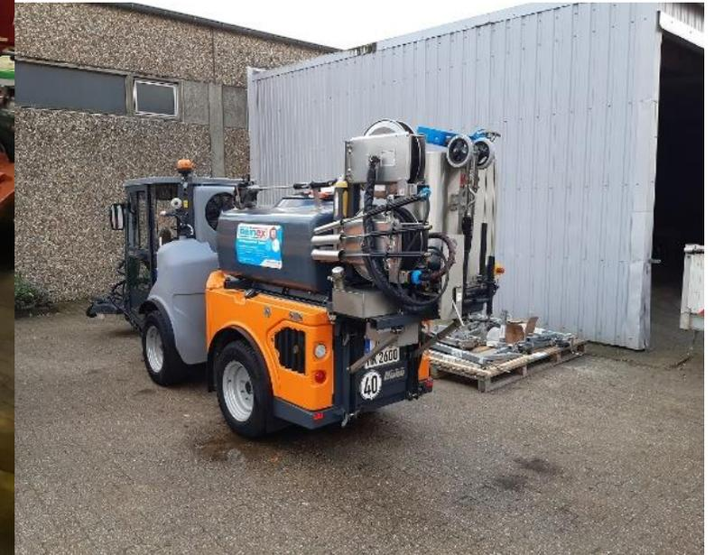
Das Trägerfahrzeug mit den Anbauten für die Wildkrautbekämpfung mit Heißwasser bzw. Heißdampf.
